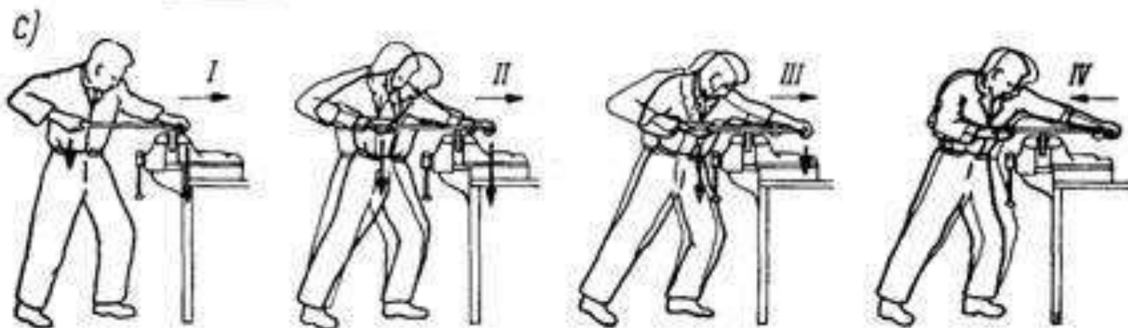
Rys. 15. Postawa przy piłowaniu a — sprawdzenie prawidłowości wysokości imadła, b — ustawienie stóp, c — kolejne zmiany postawy ciała i sił wywieranych na pilnik
